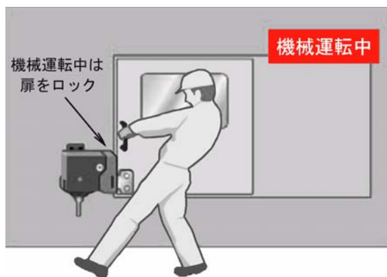
図4 ソレノイド付安全スイッチの機能
