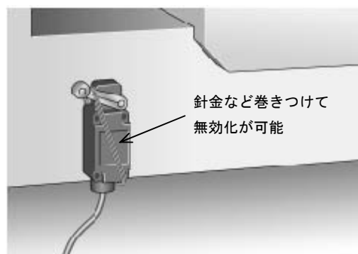
図 3 リミットスイッチの無効化の例
