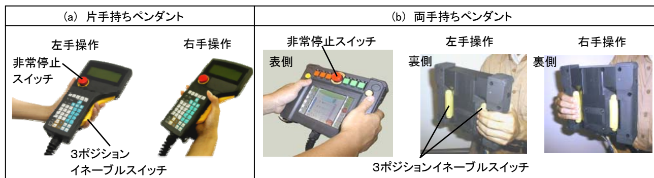
図2 ペンダントへの非常停止スイッチと3ポジションイネーブルスイッチの搭載例
