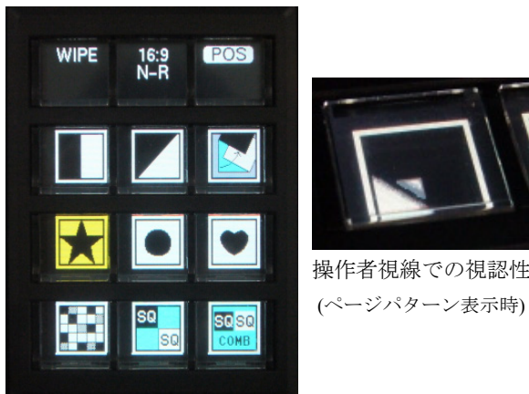
図 1 0 CC スイッチを用いたワイプパターン選択部 Fig.10 Wipe pattern selection part with CC switch.
