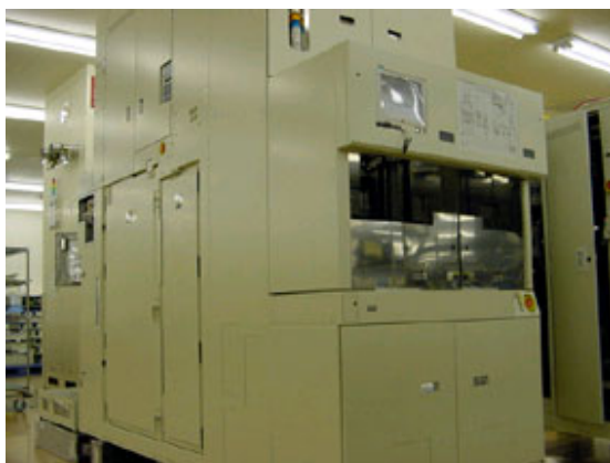
(a) 300mm 対応縦型拡散装置の外観写真
