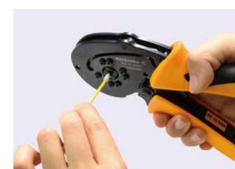
端子により線を挿入する フェールル端子
