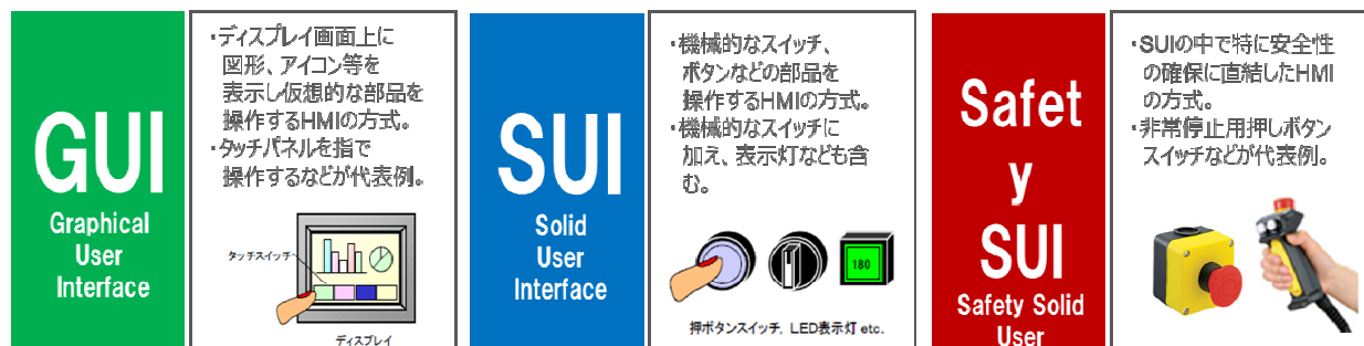
図2 HMI の方式である GUI, SUI, そして Safety SUI の概要 Fig.2 Overview of HMI methods: GUI, SUI, and Safety SUI
