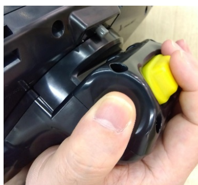
図 11 自然と指が沿うような形状 Fig.11 A shape that naturally fits finger
