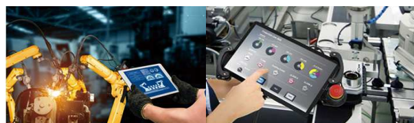
図1 タブレット端末のみと、タブレット端末に Safety SUI を付加し 協働ロボットティーチングに使用した例 Fig.1 Example of using only a tablet computer and tablet computer with Safety SUI for teaching a collaborative robot
