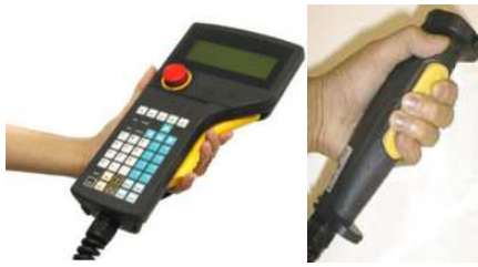
図6 イネーブルスイッチの握り方の例 Fig.6 Example of how to grip the enable switch
