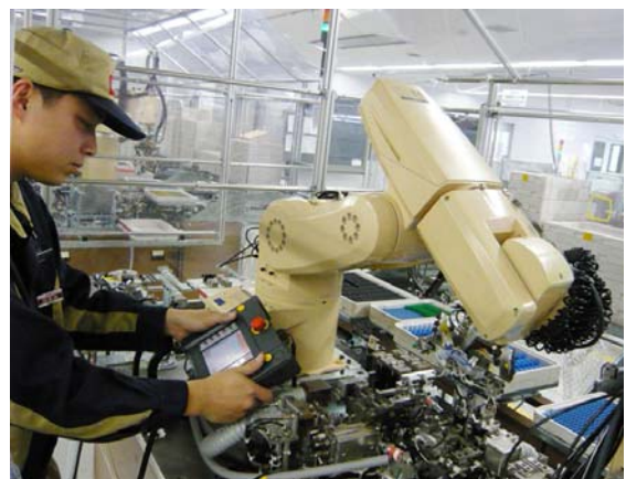
図 1(b) ロボット制御セル生産システムを オペレータが操作する様子
