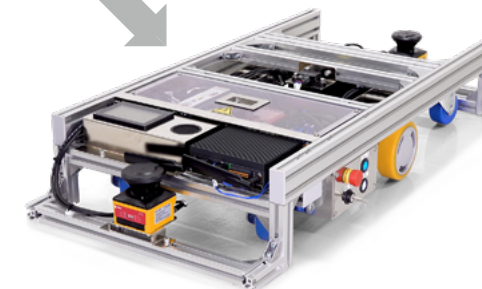
7つのモジュールを組み合わせることで、AGV・AMRを構築できるSWD Build KIT
