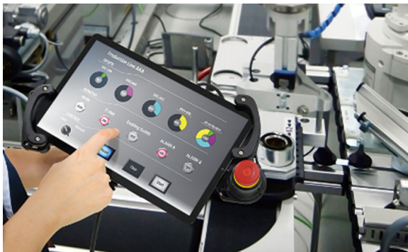
図 8 タブレット端末に Safety SUI を付加し協働ロボットティーチングに使用した例
