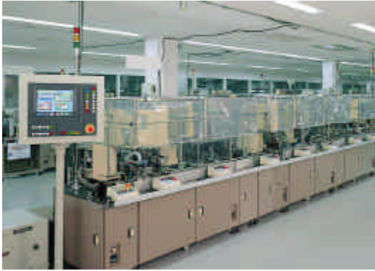
図 8 Σパネルの実使用例 1 (電気機器の自動組立てライン)
