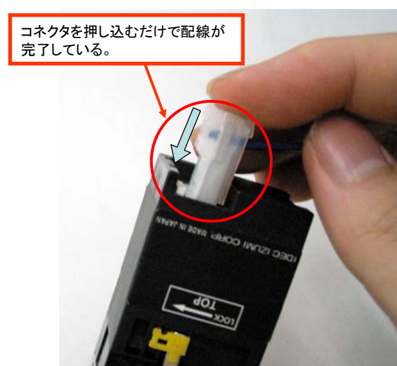
図 6 コネクタ方式を採用することで、指一本だけで配線が行えている様子
