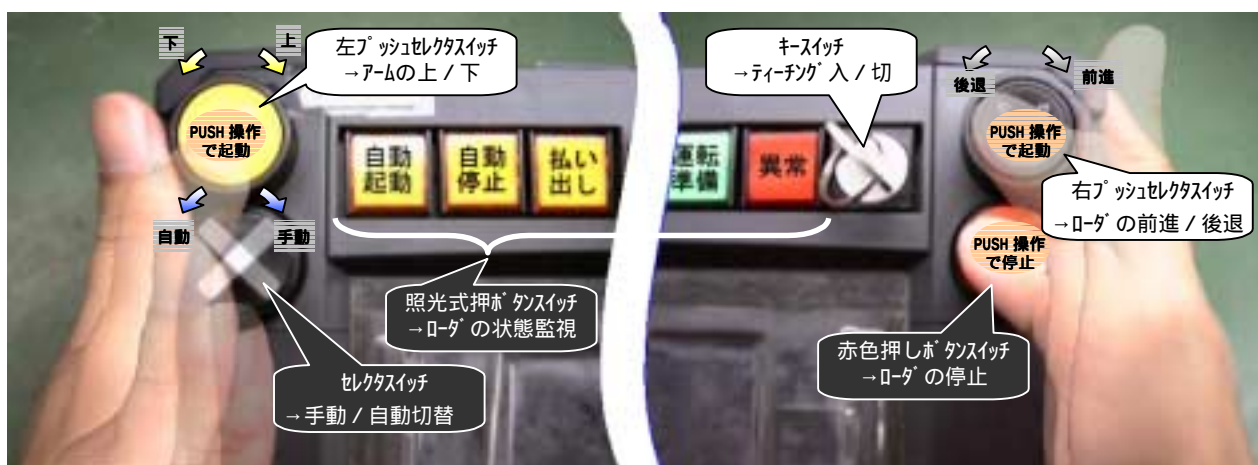
(b) 各種 SUI によるローダの実動作
