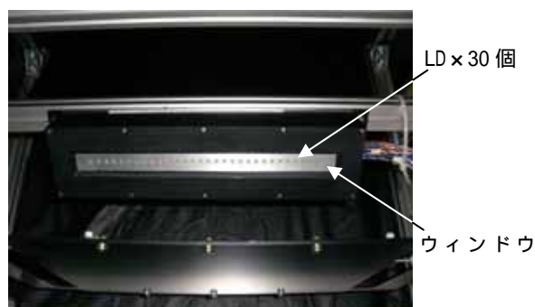
図6. レーザモジュールの外観写真
