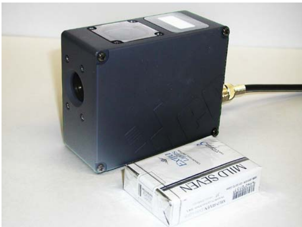
図4 プラスチック種類識別装置の構造
