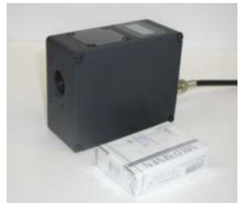
図10 小型プラスチック種類識別センサのプロトタイプ概観図
